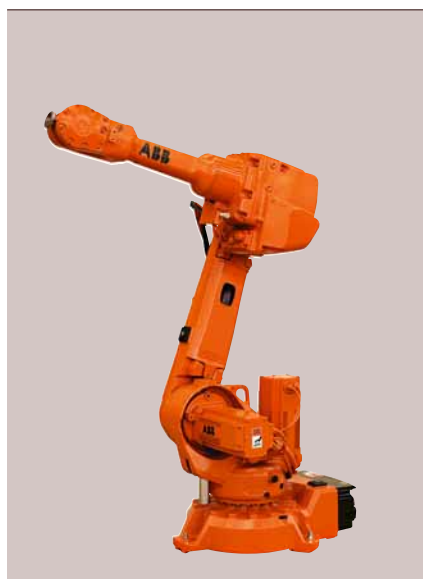
Der IRB 2600-20/1.65 mit erhöhter Tragkraft (20 kg statt 12 kg)
