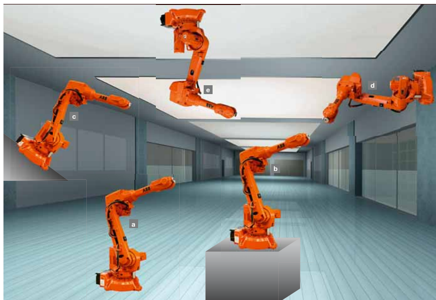
3 Montagevarianten des IRB 2600: Boden a , Shelf/Sockel b , geneigt c , Wand d und hängend e
