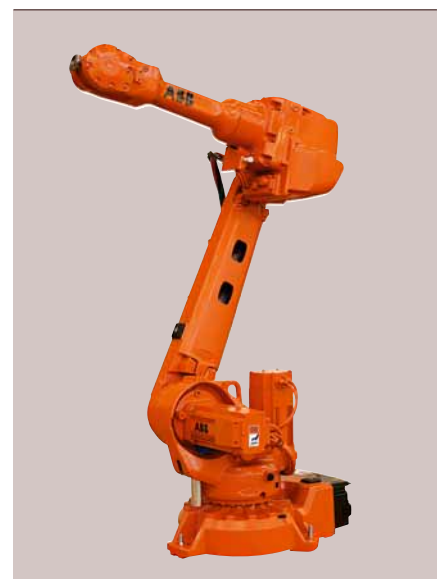
Der IRB 2600-20/1.85 mit größerer Armlänge (1,85 m statt 1,65 m)
