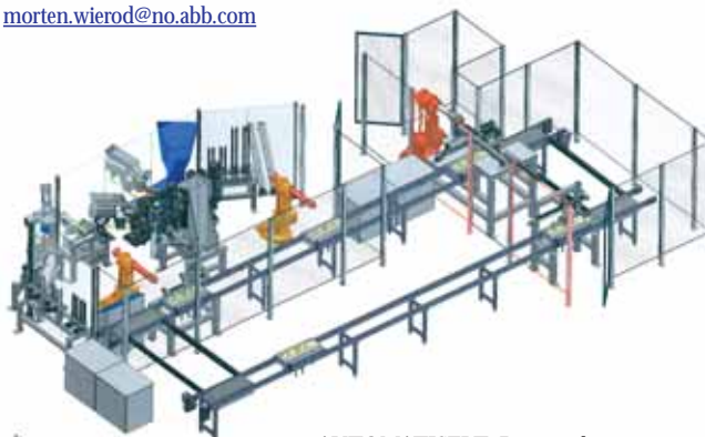
AUTOMATISERT: Dette er den nye automatiserte produksjonslinjen til ABB i Skien for den nyutviklede lavspenningbryteren.
