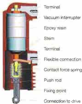
รูปที่ 3 ภาพตัดขวางของ Pole อีพอกซีหล่อแบบฝังตัว
